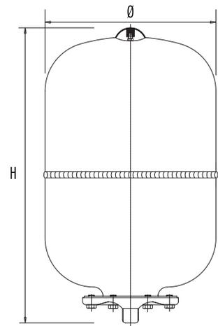
Vaso multifunzione con membrana intercambiabile per circuiti di acqua sanitaria.
